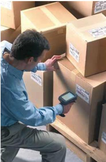
Los tags de baja frecuencia (LF) tienen una longitud de onda larga y son más capaces de penetrar sustancias metálicas delgadas. Además, los sistemas LF RFID son ideales para leer objetos con alto contenido de agua, pero el rango de lectura está limitado a 30-40 centímetros.
